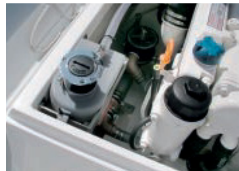
Saubere Lösungen: Kraftstoff-Einfüllstutzen mit Überlaufreservoir und stehender Ölfilter für kleckerfreien Ölwechsel
