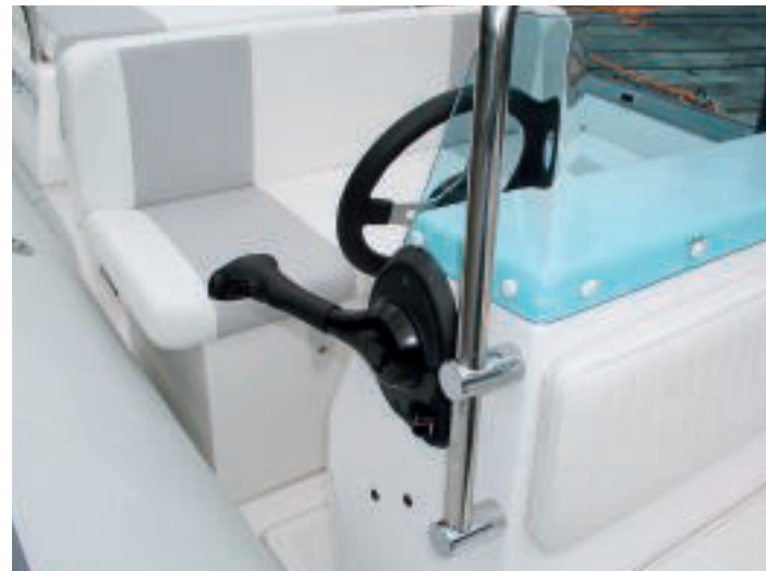
Vorn offen: Wotan mit Offshore-Steuerstand; etwas gewöhnungsbedürftig ist die zugunsten des Haltebügels um 90° nach achtern gekippte Schaltung.
